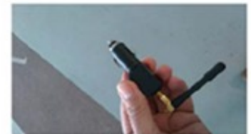
Brouilleur GPS L1 (1575,42 MHz)
